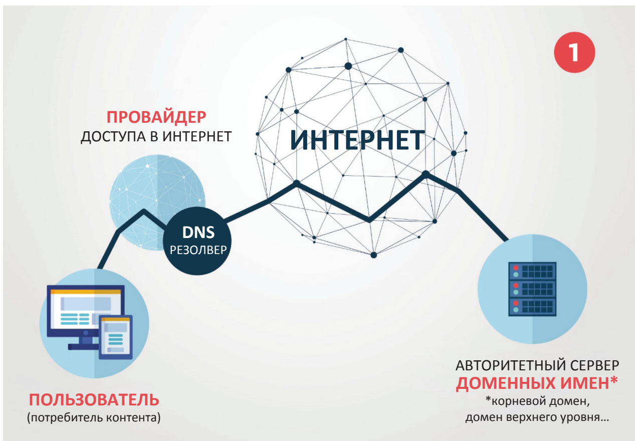
Рис. 1 Стандартная схема преобразования доменного имени без использования протокола DNS по HTTPS
